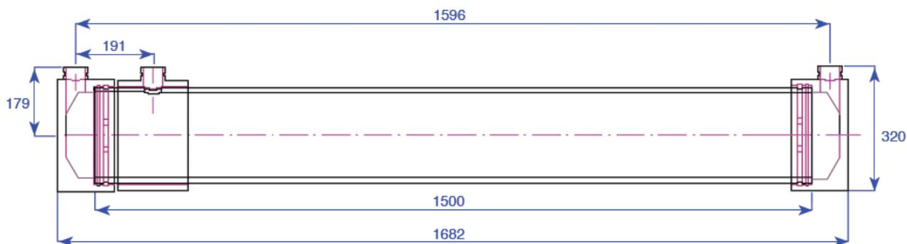
Рисунок 2: Габаритные размеры ZW700B-10060 SB 1.5 (мм)
