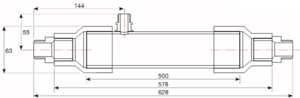
Рисунок 2: Габаритные размеры ZW700B-250
