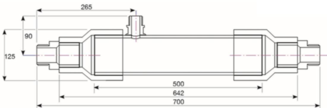
Рисунок 2: Габаритные размеры ZW700B-450
