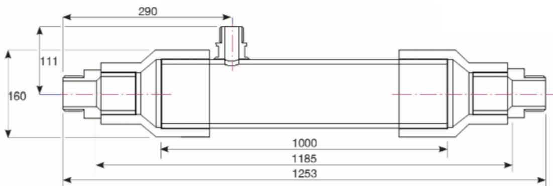
Рисунок 2: Габаритные размеры ZW700B-6100
