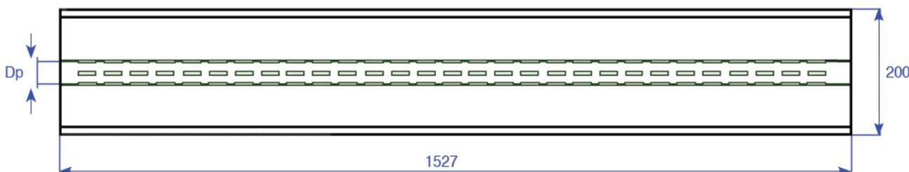
Рисунок 2: Габаритные размеры ZW700B-8060X (мм)
